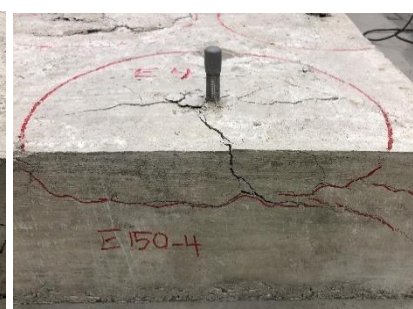
Infästning nära kant ( C=150 mm)
