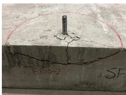
Infästning nära kant ( C=100 mm)
