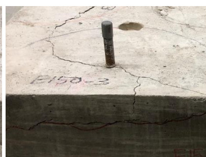
Infästning nära kant ( C=150 mm)
