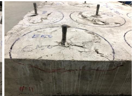
Infästning nära kant ( C=150 mm)
